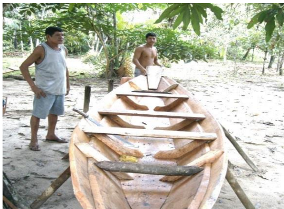
Figura 15 – Fotografia da construção de uma canoa.
