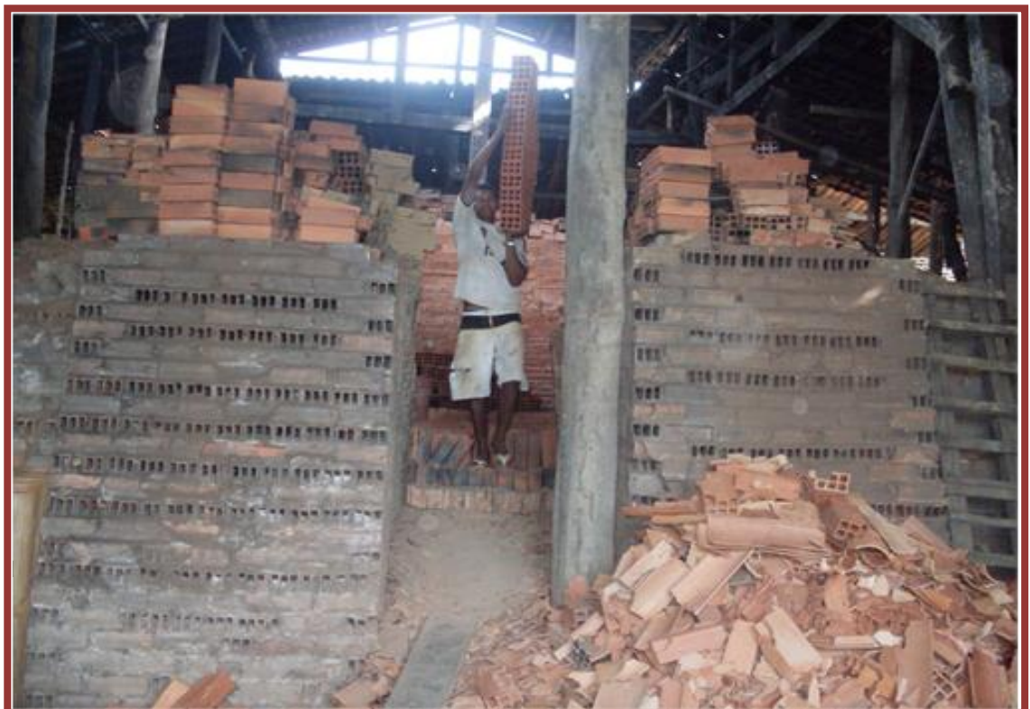
Foto 14 - Trabalho de empilhamento no forno - tijolos crus (Autor Salatiel,2011)
